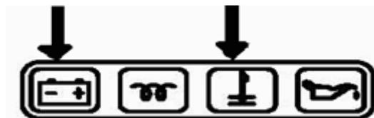
Wenn die Motor Temperatur Kontrolle oder Öldruck Kontrolle leuchten und der Alarmton ertönt, ist entweder die Motortemperatur zu hoch oder der Öldruck zu niedrig. Der Motor ist sofort zu stoppen und nach den Fehler zu suchen und zu beseitigen.
