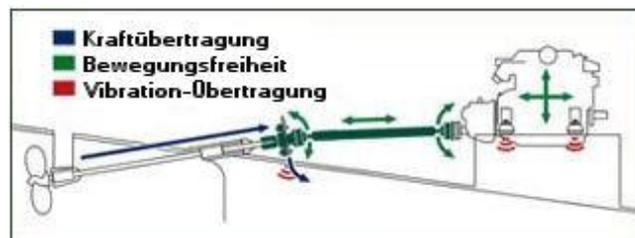
Dank der Gelenkwellen, die beide bis zu 8 Grad gedehnt werden können, insgesamt also 16 Grad, kann der Motor mit Hydradrive in einer mehr waagerechten Position montiert werden. Dies erleichtert die Installation des Motors, und eine genaue und permanente Anpassung des Motors kann erzielt werden indem Hydradrive den Motor folgt, wenn er sich in der Aufhängung setzt. Eine bessere Platzoptimierung wird ebenso erzielt.
