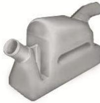
Er soll ein zurücklaufen des Wassers aus dem Abgas-System verhindern. Es hat auch eine gewissen Schalldämpfende Wirkung. Dieses sollte horizontal verbaut werden. Hier sind die jeweiligen Herstellervorschriften zu beachten. Auf eine ausreichende Dimensionierung ist zu achten.
