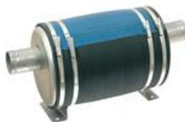
Der Schalldämpfer kann vor oder hinter einem Schwanenhals montiert werden. Während des Betriebs des Motors ist der Schalldämpfer mit Wasser gefüllt. Dies bedeutet, dass das Gewicht erhöht ist und der Schalldämpfer zusätzliche Unterstützung benötigt. Montieren Sie den Schalldämpfer, so dass das Wasser abfließt, wenn der Motor gestoppt. Es sind die Einbauvorschriften des Herstellers zu beachten!
